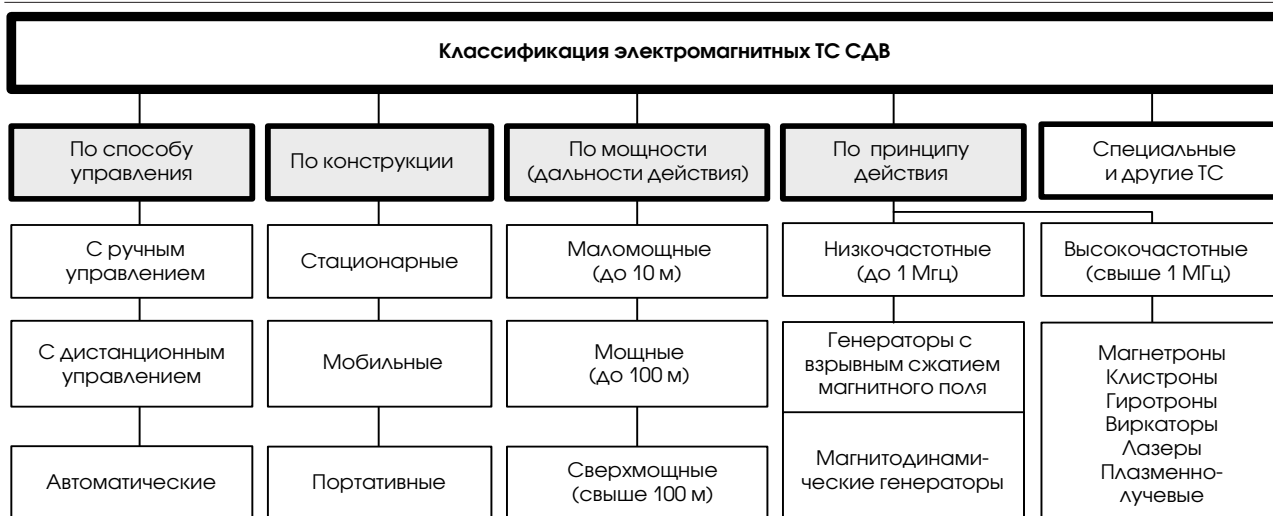
Рис.6. Классификация ТС СДВ по эфиру (электромагнитных ТС СДВ).
