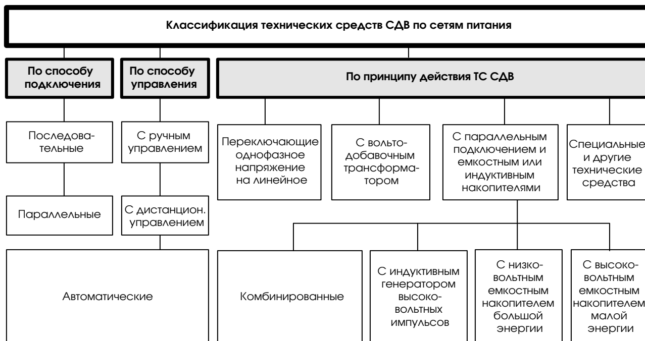
Рис. 4. Классификация технических средств СДВ по сетям питания.
