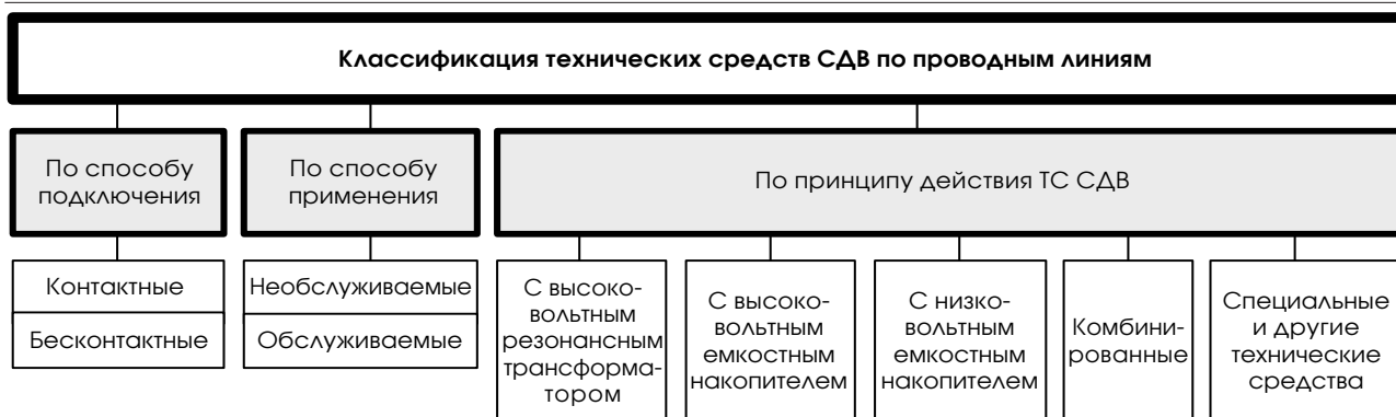
Рис. 5. Классификация ТС СДВ по проводным линиям.
